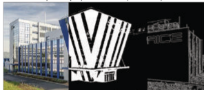
Obr. 1 Příklad zadaného obrazu (vlevo), maska barevného klíčování pro modrou barvu (uprostřed) a maska hran z Cannyho hranového detektoru (vpravo).
