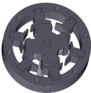
Obr. 1 mechanické uspořádání stator - rotor
