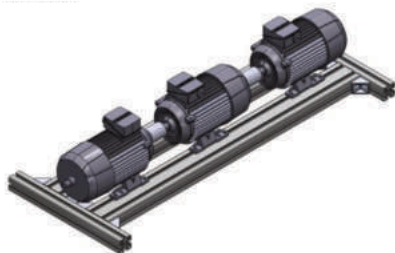
Obr.1 koncept měřicího stanoviště
